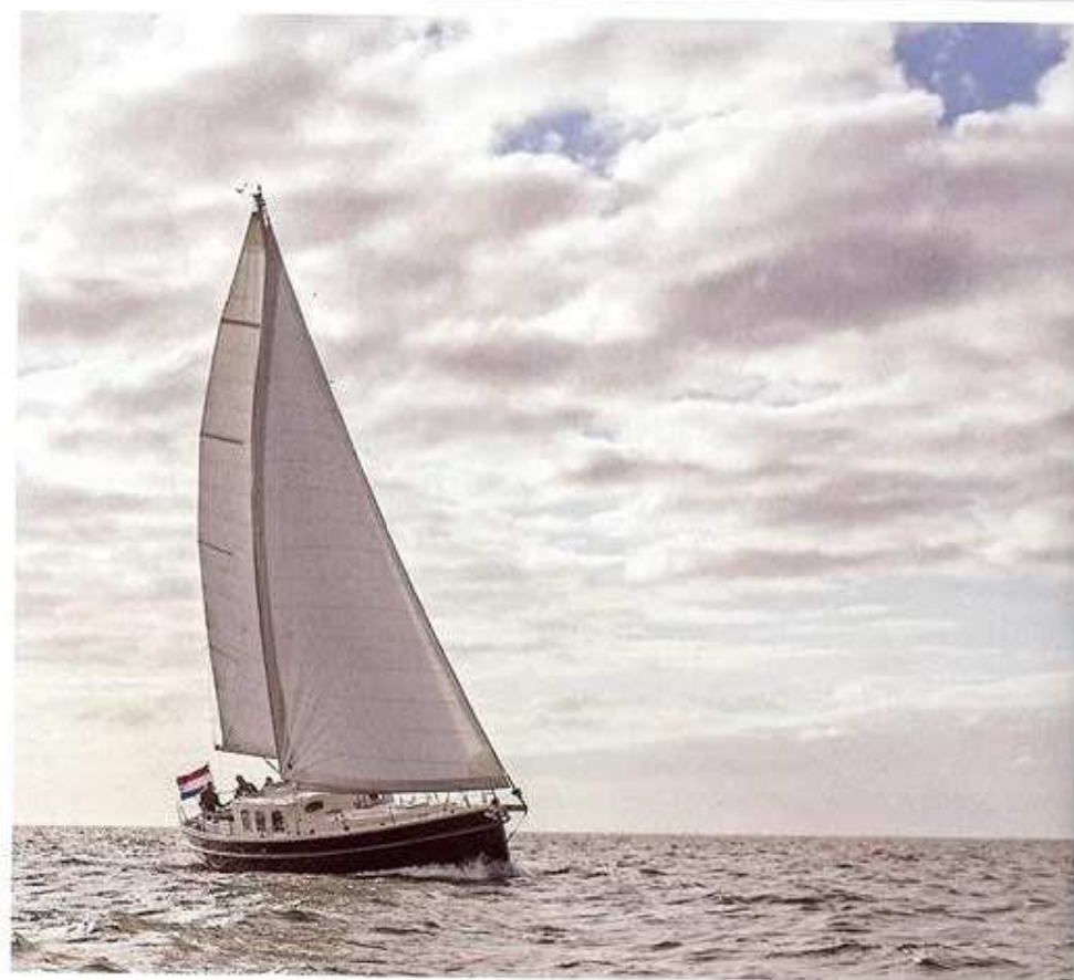
Het kottertuig biedt veel voordelen. Bij veel wind draai je de genua weg en voer je alleen de kleine kottersfok met dubbel gereefd grootzeil
